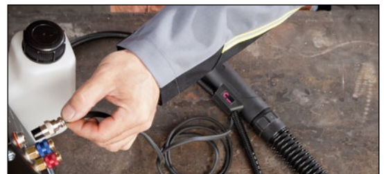
8. Connecter le contrôleur à l'aide de sa fiche au refroidisseur.
