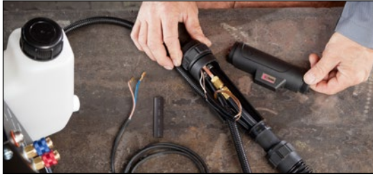
1. Ouvrir le renfort de faisceau côté poste.
