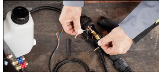
2. Déconnecter l'un des 2 fils de commande.
