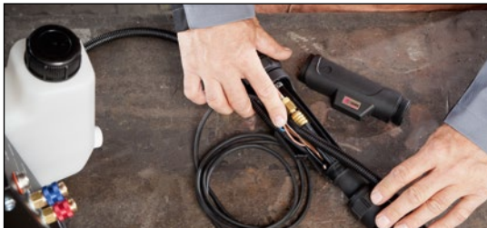
5. Positionner les fils dans le renfort.
