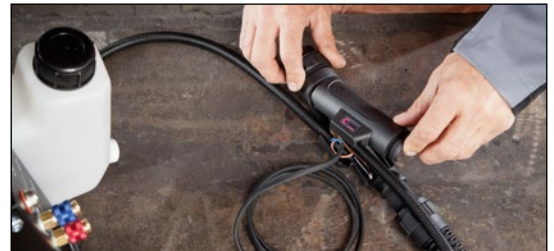
6. Faire sortir les fils du contrôleur par l'ouverture.
