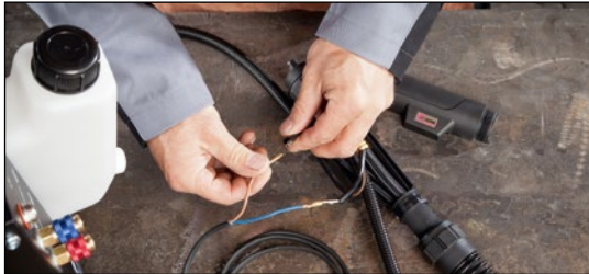
3. Connecter les fils de commande séparés avec les fils du contrôleur.
