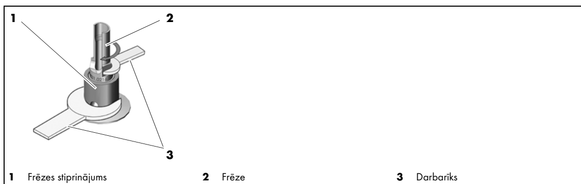
11.att. Frēzes uzstādīšana
